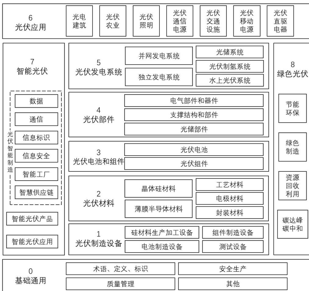
图 2 太阳能光伏产业综合标准化技术体系结构
